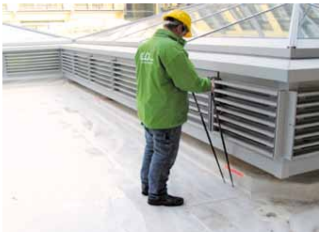
Collaudo dello strato impermeabile con la ricerca dei punti di "messa a terra".
