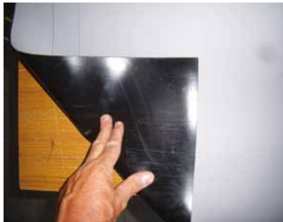
Controllo visivo su membrane impermeabili realizzate con facce di colore contrastante (sistema "Signal layer").
